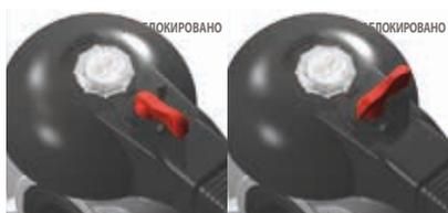
Благодаря многофункциональной рукоятке и красному фиксатору поворота, расположенному на рычаге рукоятки, можно выполнить поворот на 0-90° и пошаговый поворот с 10 промежуточными положениями и стопорной блокировкой: рукоятку можно заблокировать в любом из 10 положений, просто нажав на фиксатор поворота Free-Lock. Помимо этого, можно установить на рукоятку навесной замок для защиты оборудования от несанкционированного доступа.
